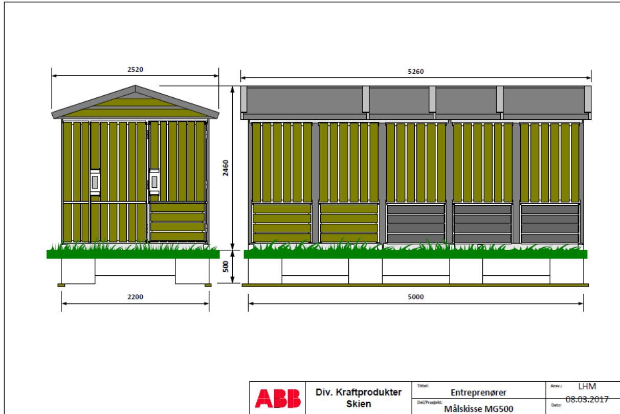
Figur 6 Skisse ABB kiosk 2,5 MVA II
