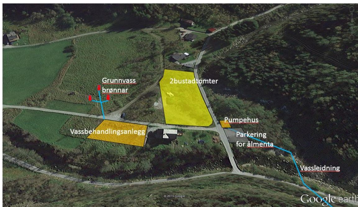
Figur 9: Bilete viser nye tiltak som er planlagt; grunnvassbrønnar, vassbehandlingsanlegg, to nye bustadtomter, pumpehus, parkering for ålmenta og vassleidningar. Vassleidningen til høgre i bilete går til høgdebassenget (COWI, 2018).
