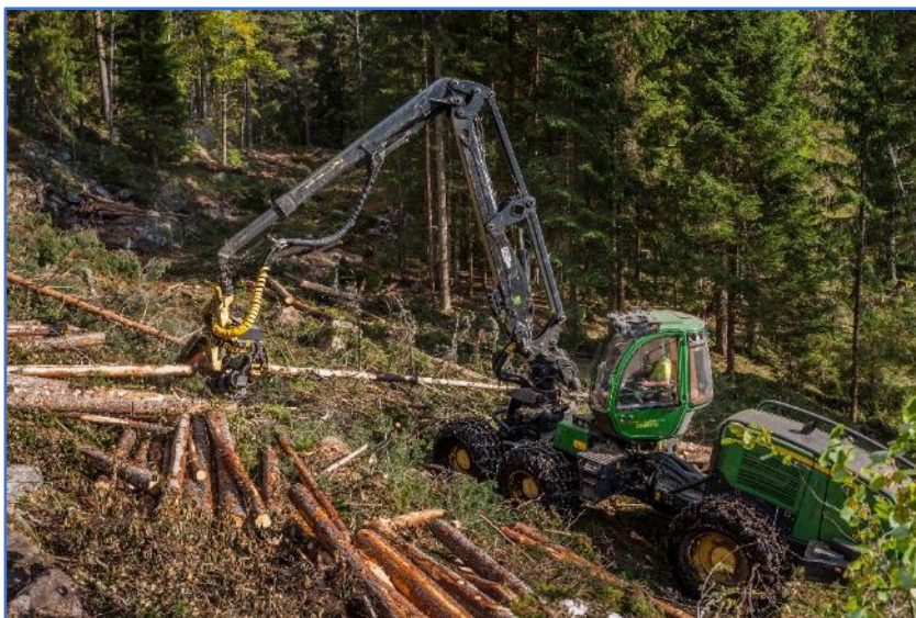
Figur 8-1 Rydding av skog i ledningstraséene gjøres i hovedsak med skogsmaskiner slik skogbruket driver i dag.
