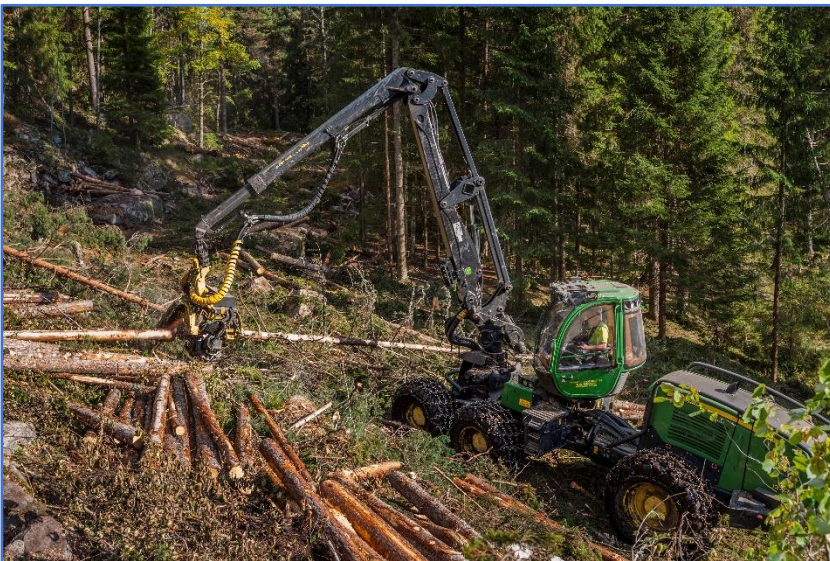
Figur 9-4: Rydding av skog i ledningstraseene gjøres i hovedsak med skogsmaskiner slik skogbruket driver i dag.
