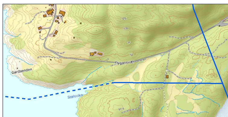
Figur 8-7: Trasealternativ 1.3 (blå heltrukket strek luftledning og stiplet strek sjøkabel). Sjøkabelen trekkes helt opp til kabelendemasten som planlegges plassert i kanten av innmarka ca. 90 meter fra sjøkanten.
