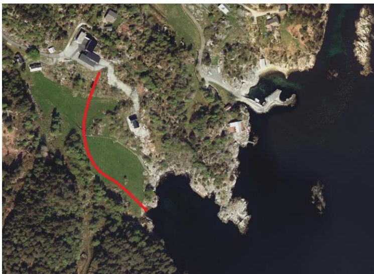
Figur 6-5: Innføring til Otteråi. Kabel i grøft mellom landtak og stasjon
