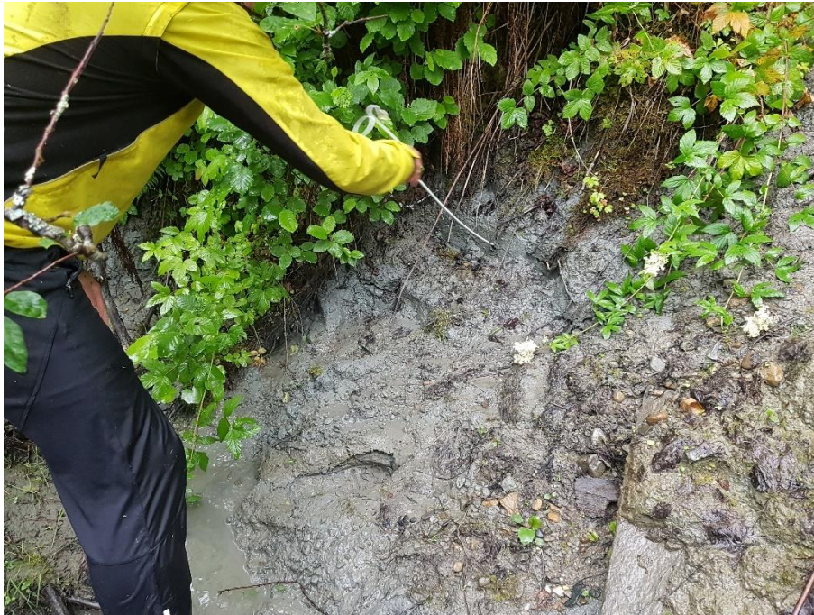
Figur 3: Overflateglidning med bløt leire.
