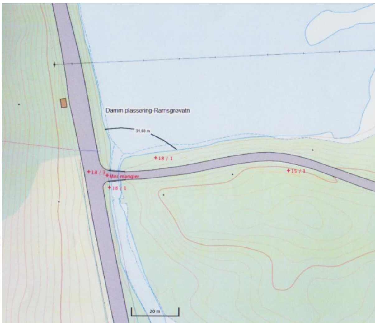
Figur 5 Kartet viser utløp Ramsgrøvatnet med omtrentlig damplassing. Dam i blå farge er ca. 32 m lang, overløp er planlagt til 15 meter lengde.
