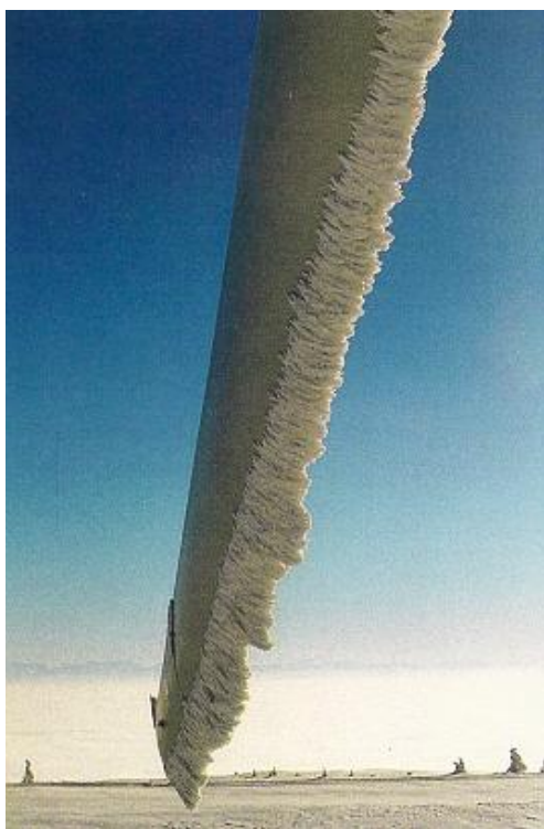
Figur 2 Ising på vindturbinvinge i Finland. Bildet er gjengitt med tillatelse fra Finsk Meteorologisk Institutt.
