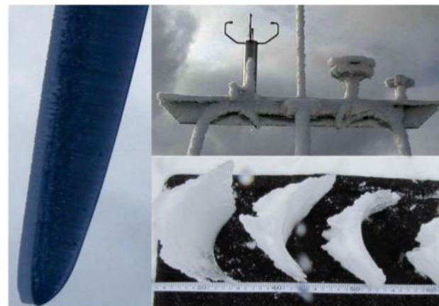
Figur 6 Sammenheng mellom islast på standardlegeme i navhøyde og akkumulert is på en turbinvinge. Bildene er gjengitt med tillatelse av Wadham-Gagnon ved TechnoCentre éolien. Isklassene er hentet fra ISO-12494 som omhandler ising på konstruksjoner.
