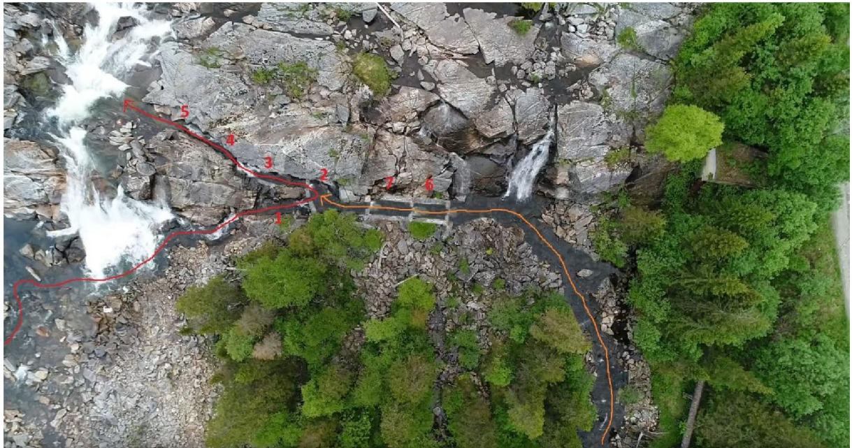
Figur 9. Samme bilde som i figuren ovenfor, men hvor en tenkt ny fisketrapp er manipulert inn i bildet for å illustrere en ny vandringsvei opp (6 og 7). Kulpene 1 til 5 ligger langs dagens vandringsvei (rød strek) for fisk. Den gule streken markerer vandringsveien som kan bygges ved etablering av kraftverksutløp til høyre i bildet.
