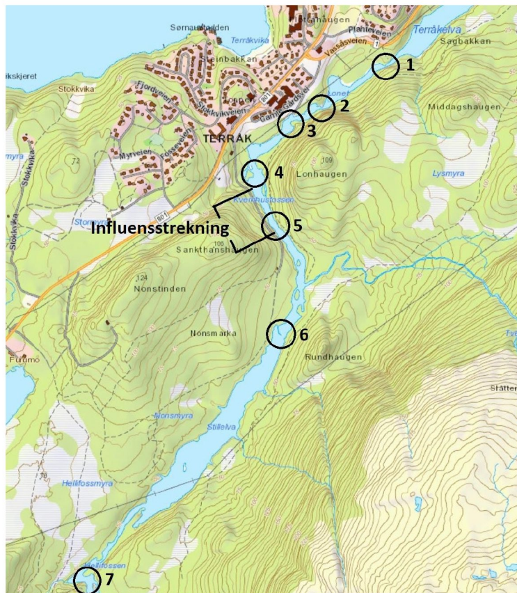
Figur 1. Lakseførende strekning i Terråkvassdraget med sju vandringshindre markert med svart sirkel. Den delen av elva som påvirkes av kraftverksutbygging er markert med svarte linjer («influensstrekning»).
