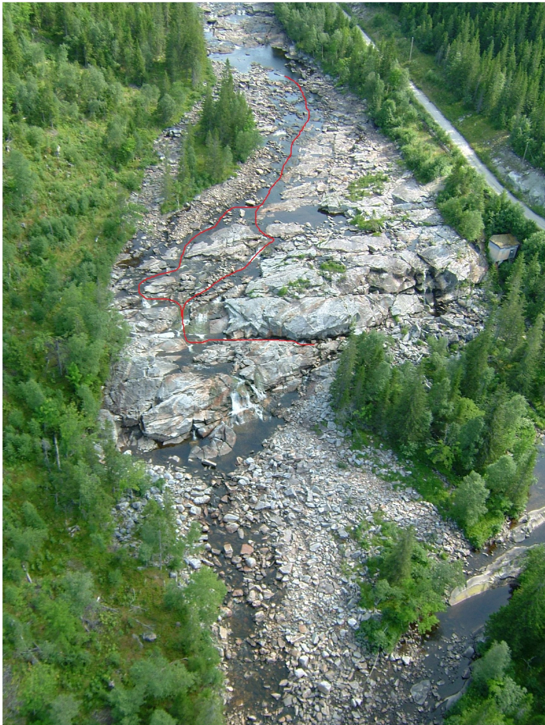
Figur 13. Nedre del av minstevannstrekningen med inntegnet mulig vandringsrute med rød strek. Vannføringen på datoen bildet ble tatt, var svært lav og mindre enn planlagt minstevannføring.
