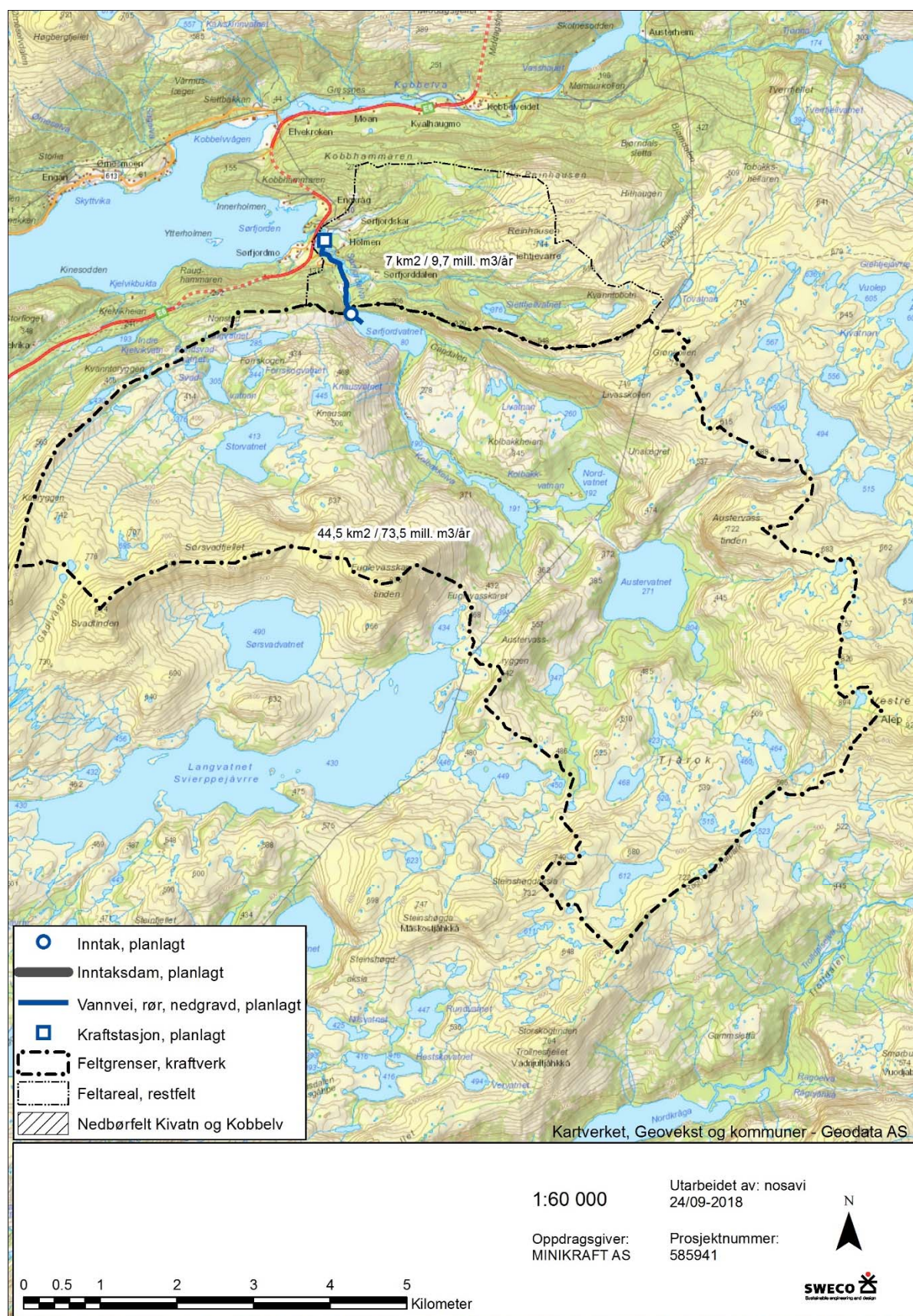
Figur 1. Kart som viser nedbørfeltet til kraftverkets inntakspunkt og restfelt. Kraftverket og inntakspunkt skal og tegnes inn.
