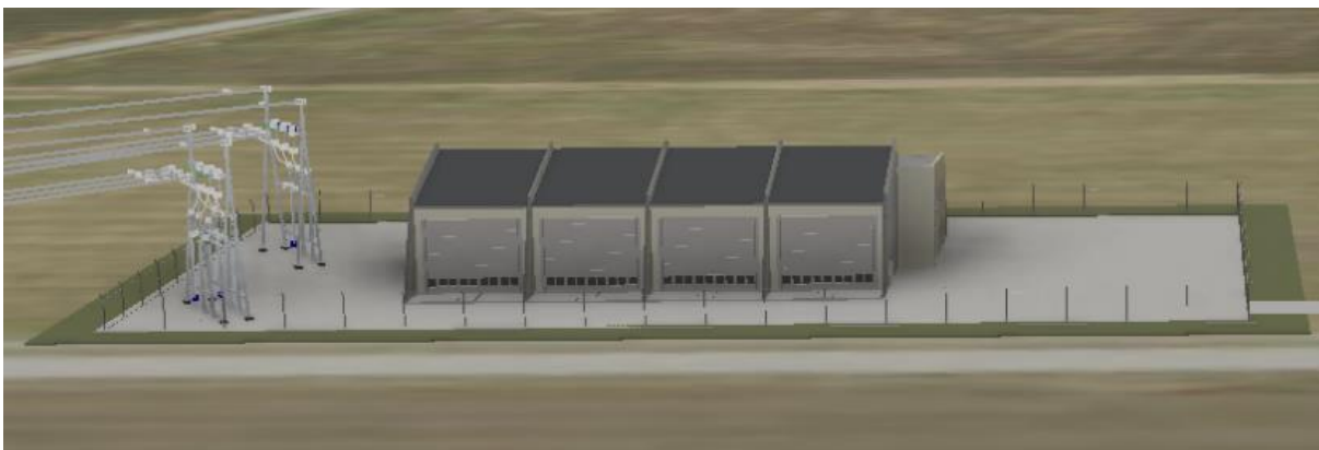
Figur 3.3. Prinsippskisse av kapslet, gassisolert (GIS) transformatorstasjon
