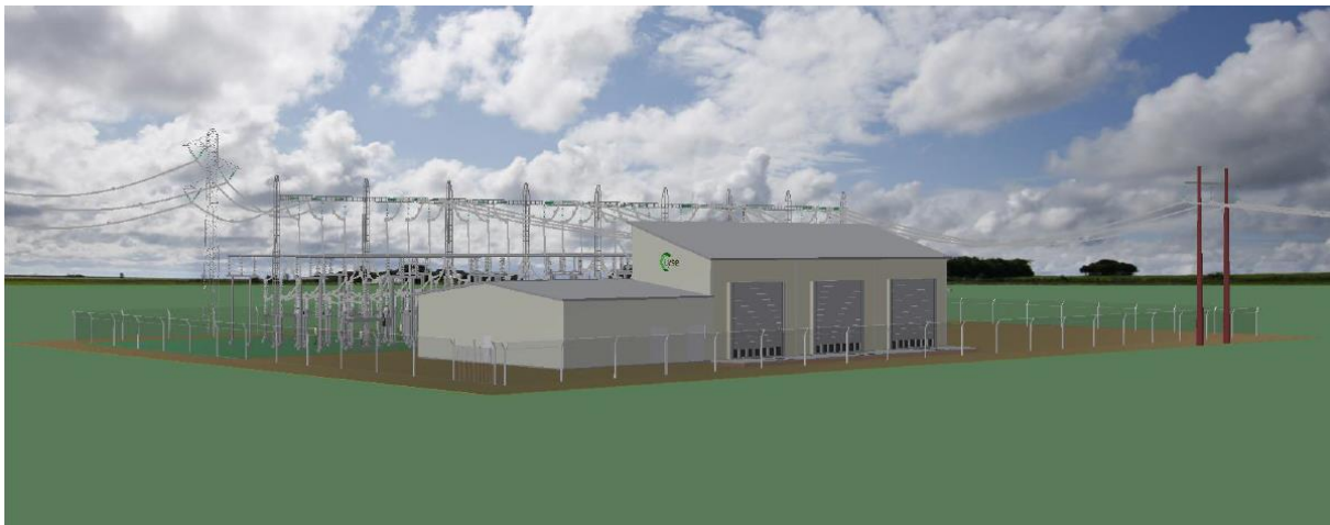
Figur 3.2. Prinsippskisse av utendørs, luftisolert (AIS) transformatorstasjon
