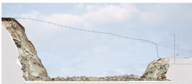
Figur 20 Snittet til venstre viser et eksempelvis sidetak som utvidelse av et vegrom der det allerede er et inngrep i form av en viss høyde på skjæringen. Det er tatt ut masser som et lite krater, for å kunne redusere antallet uttak. Til høyre vises en anbefalt disponering av tilgjengelige masser, for et naturligt uttrykk.
