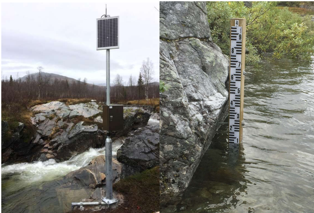
Figur 6. Eksempel på målestasjon for minstevannregistrering med vannstandsskala.
