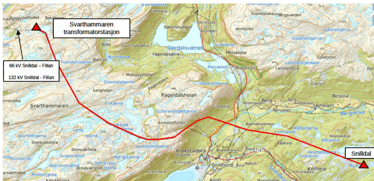
FIGUR 3: 132 kV TRASÉ SVARTHAMMAREN – SNILLDAL
