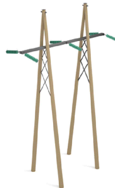
d) A-mast Forankringsmast/vinkelmast
