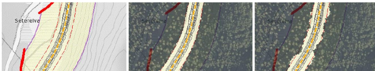
Figur 3 Hogstlinja vises i plan som ei teoretisk rett linje, vist med rød sti på tegning til venstre. Ved hogst er det ønskelig at denne gis ei organisk utforming (som vist til høyre) som blir mindre iøynefallende enn den teoretiske linja (vist i midten).
