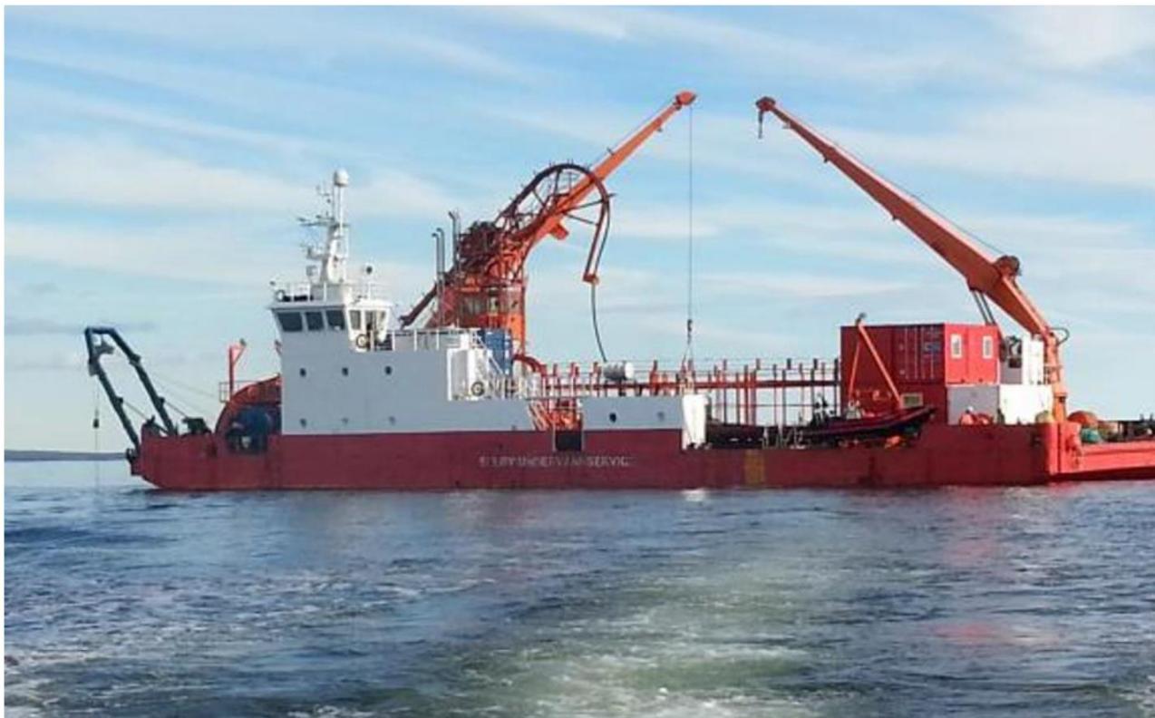
Figur 6. Utleggingsfartøyet for sjøkabelen, CLB Nautilus Maxi fra Seløy Undervannsservice AS. Fartøyet har bl.a. fjernstyrt ROV for undervannsoperasjoner som brukes for forhåndskontroll av traseen, løpende kontroll under utleggingen og en etterkontroll av kabelen (og evt. justeringer på sjøbunnen).
