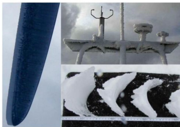
Figur 4-4 Sammenheng mellom islast på standardlegeme i navhøyde og akkumulert is på en turbinvinge. Bildene er gjengitt med tillatelse av Wadham-Gagnon ved TechnoCentre éolien. Isklassene er hentet fra ISO-12494 som omhandler ising på konstruksjoner.
