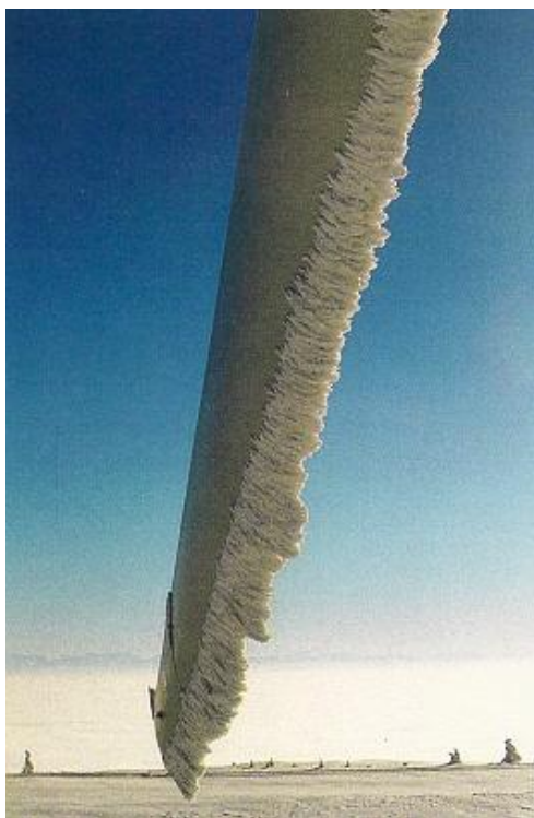
Figur 2-1 Ising på vindturbinvinge i Finland. Bildet er gjengitt med tillatelse fra Finsk Meteorologisk Institutt.
