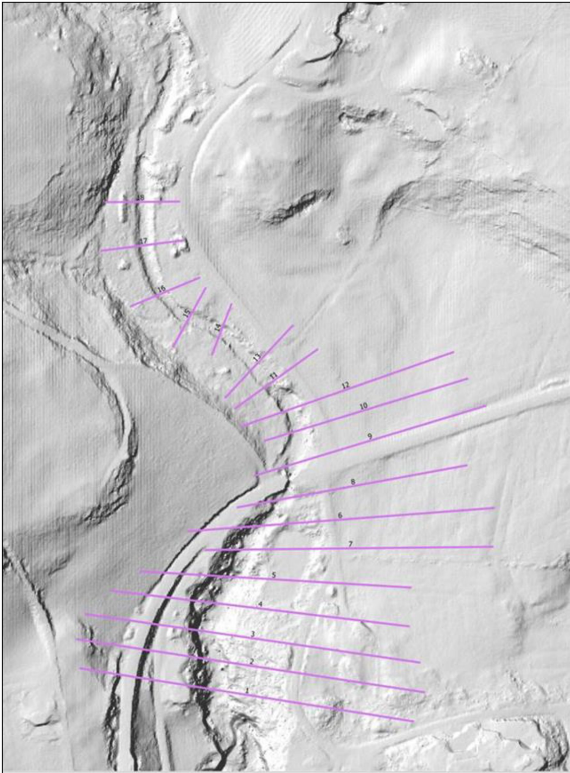
Vedlegg 2 Tverrprofiler for HEC-RAS 1D-modellen. Planområdet ligger mellom profil 4 og 7.
