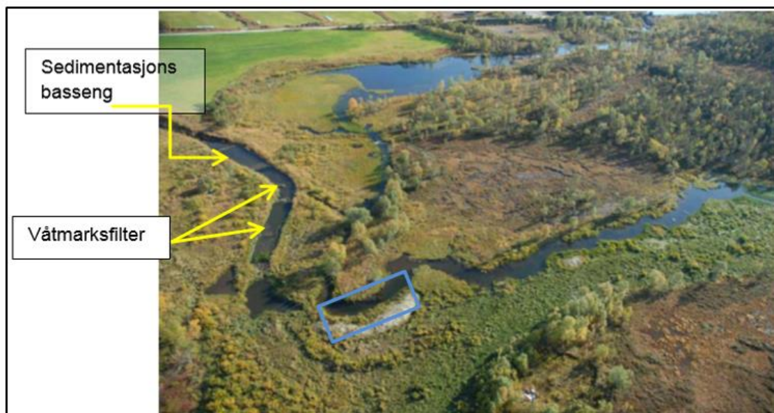
Flyfoto av fangdam med sediment-felle og våtmarksfilter. Disse ble anlagt nederst i jordbrukskanslen etter at denne var rehabilitert. Børselva er nå gjenåpnet og gitt et nytt løp i det gamle elveleiet. I den delen som er markert med en blå firkant ble det gravd ut en riktig stor og dyp kulp (> 5 m - med «langemann»). I dag er denne helt fylt opp med finmateriale, som følge av forsøk med spyleflommer. Årsaken var knyttet til erosjon i avsnittet på strekningen opp til oppstrøms terskel i Børselva. Øverst til høyre ses Børsvannet. Helt til høyre og ca 100 m nedstrøms ligger øvre dukområde.
