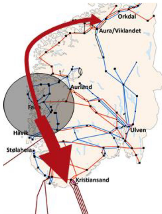
Figur 3-8 Mesteparten av den økte produksjonen legger seg på ledningene sørover på Vestlandet
