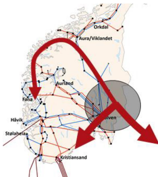
Figur 3-5 Mer produksjon på Østlandet fører primært til mer flyt vestover over Flesaker og videre på forbindelsene til kontinentet, og over Haslesnettet mot Sverige. Vi ser også at flyten på Vestlandet øker sørover fra Samnanger og at flyten sørover i Gudbrandsdalen dempes.
