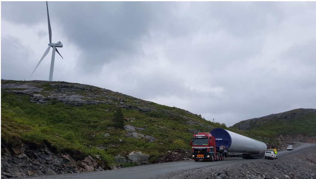
Figur 5: Transport av tårnelement i Roan vindkraftverk i Trøndelag. Foto: NVE/Inger Helene Waagaard Riddervold.
