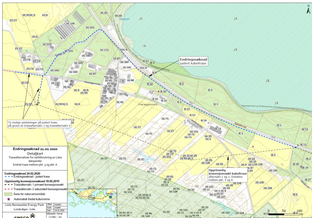
Figur 2 Justert trase mellom punkt 3 og punkt A
