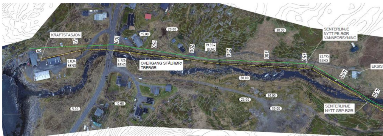
Figur 3 Nedre del av traséen for turbin- og vannforsyningsrør
