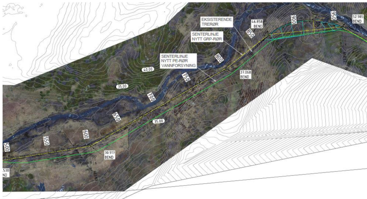
Figur 2 Nedgravd del av traséen for turbin- og vannforsyningsrør oppstrøms elvekryssing
