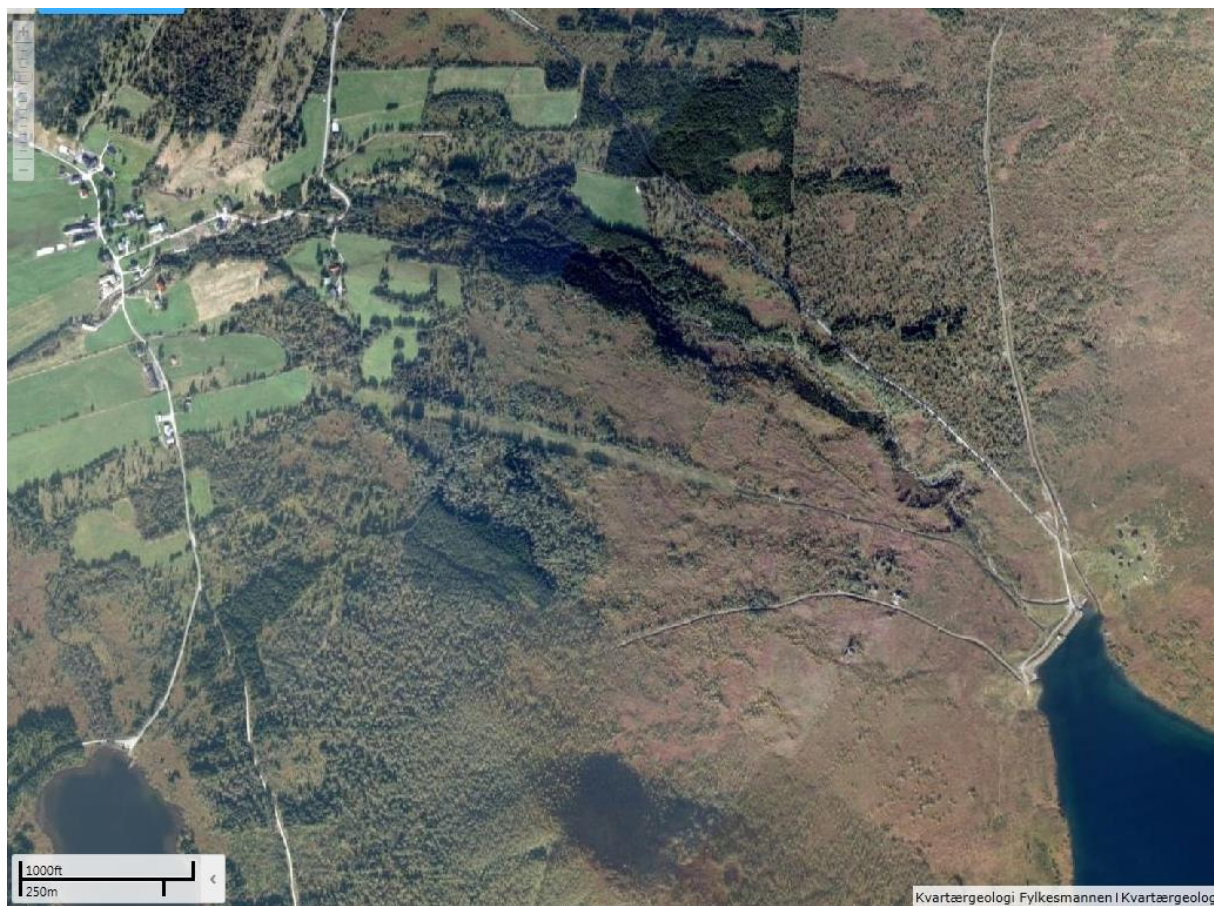
Figur 4. Dette flyfotoet er henta frå Gislink og er frå 2009. Nede i høgre hjørnet ser vi litt av Kvanndalsvatnet med demninga med inntak for Bjørddal Kraftverk. Nedanføre demninga ser ein tydeleg røyr-gata og bukkane som røyret ligg på. Om lag 250 m nedanføre inntaket er det ein knekk på røyret før ho held fram ytterlegare om lag 440 m oppe på bakken. Vidare er røyret grave ned og traseen syner tydeleg på fotoet før ho held fram vidare under bakken. Som ein ser fører nedgravinga til ei viss drenering i grøftetrasèen. Mellom anna oppslaget av trær og buskar viser det. På begge sider av demninga ser ein grøfter som er grave med føremål å føra vassig og nedbør inn i Kvanndalsvatnet. Historiekapitlet viser at dette vart gjort i 1940.
