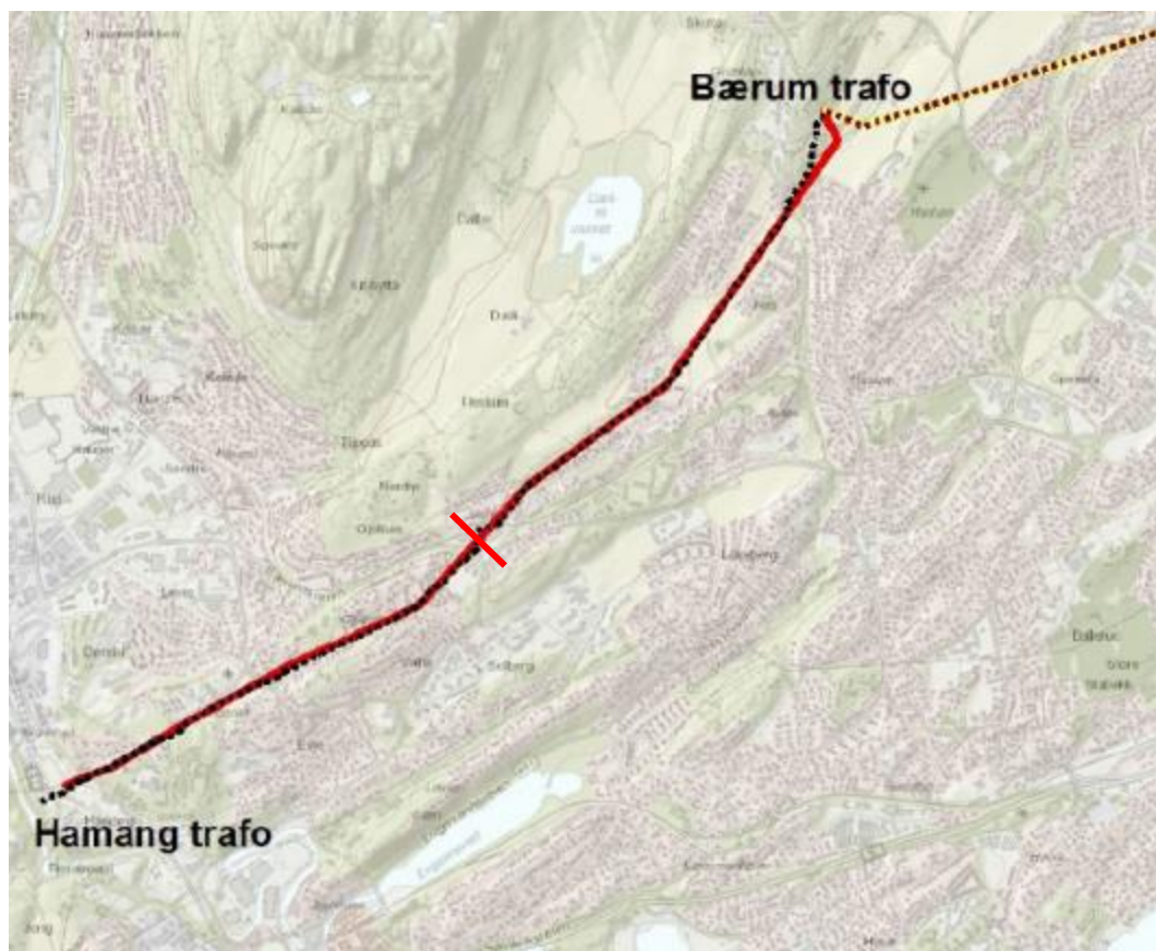
Figur 5-1. Alternativer med grøft eller luftledning Hamang trafo-Bærumsveien (kap.5.1) og Bærumsveien-Bærum trafo (kap.5.2). Kilde: Statnett.
