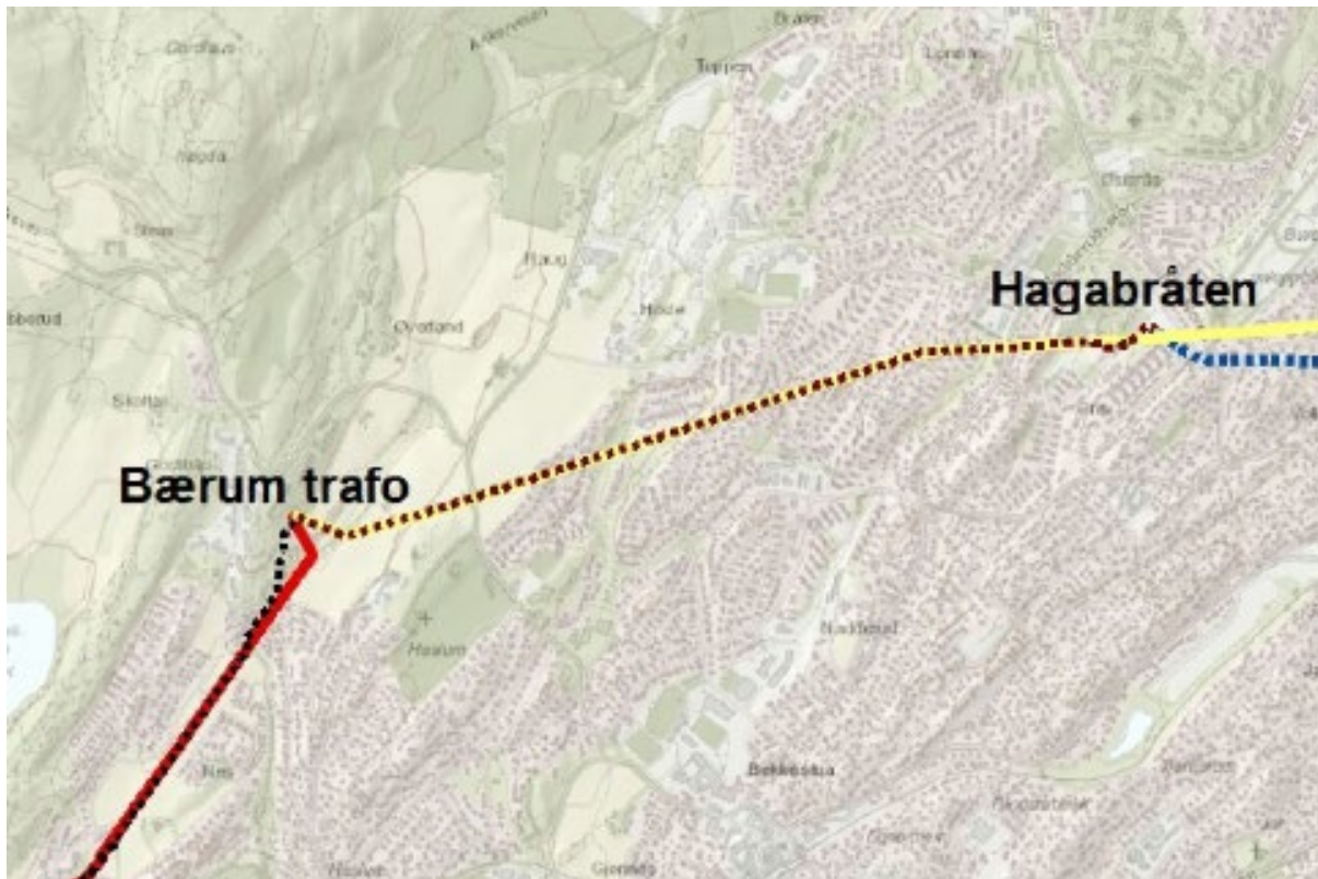
Figur 5-6. Trasealternativer med luftledning (gul farge) eller kabel i grøft rød stiplet linje mellom Bærum stasjon og Hagabråten. Kilde: Statnett.
