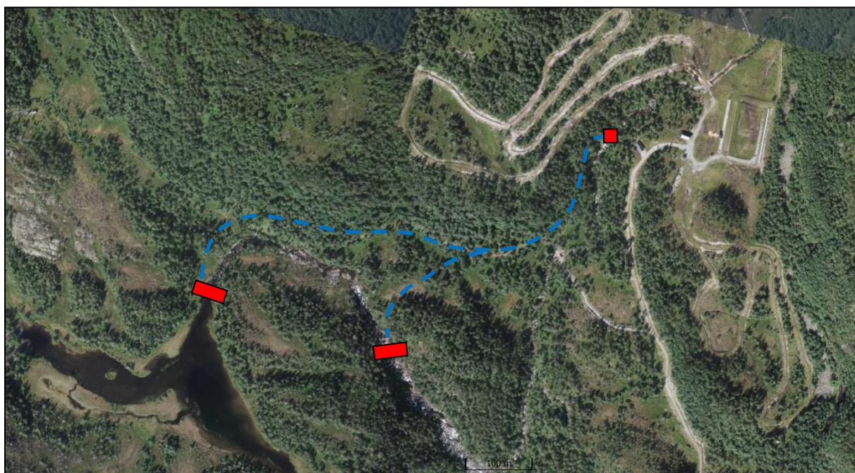
Fig. 73. Skoglandskapet mellom Holdhustjørna og etablert skianlegg ved Åreidselva i øst. Trasé for overføring i rør er vist til a) Holdhustjørna i hovedalt. og b) til inntaksområdet i Kvanndalselva for alt. 1 og 2.
