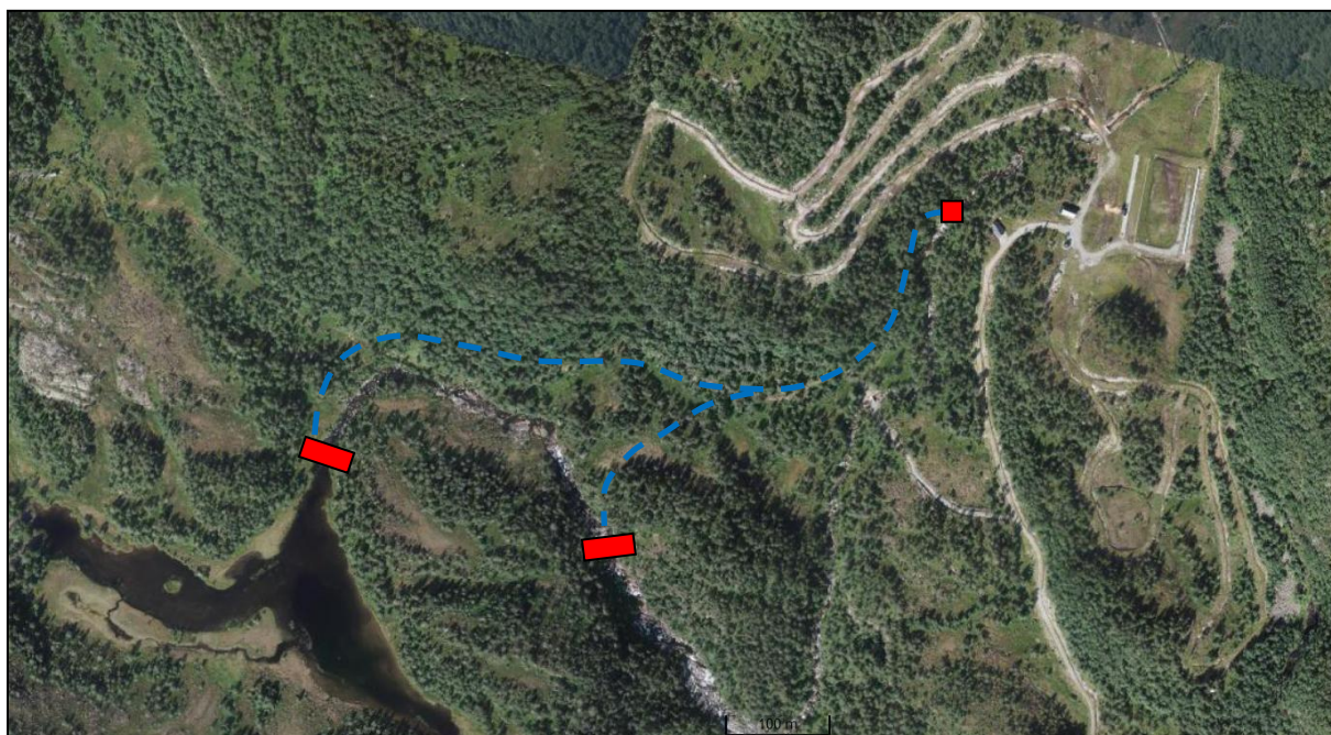
Fig. 67. Skogslandskapet mellom Holdhustjørna og etablert skianlegg ved Åreidselva i øst. Trasé for overføring i rør er vist til a) Holdhustjørna og b) til inntaksområdet for alt. 1 og 2. Uttak av morenemasser langs trasé er aktuelt (SKL 2017). Bygdastølen skianlegg er både et eksisterende inngrep i natur og landskap, men på den annen side et anlegg som gir verdi for friluftslivet.
