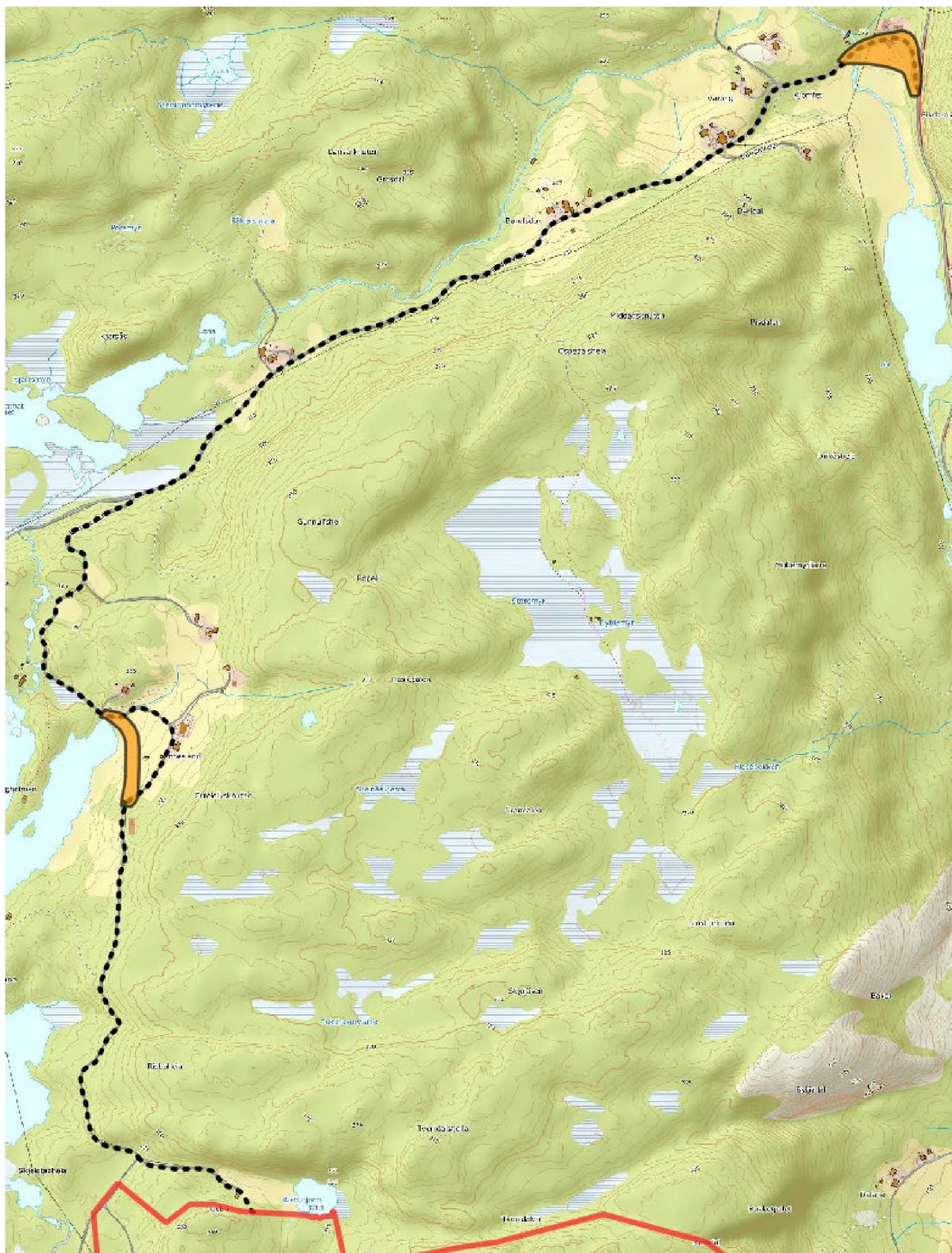
FIGUR 18 ORANGE SONER VISER PRIMÆRE TILLEGG/AVVIK FRA KONSESJONSGITT ADKOMSTVEI LANGS LUNDEVEIEN SOM ER VIST MED SORT STIPILET LINJE
