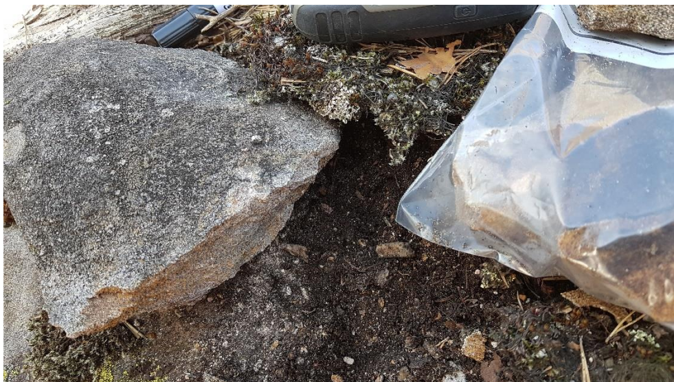
Figur 3: Båndgneis, fin-middelskornet kvarts-plagioklas-biotitt gneis funnet ved prøvepunkt 3 – ligger under pegmatitten, svovel 0,132 %, peroksid ingen reaksjon
