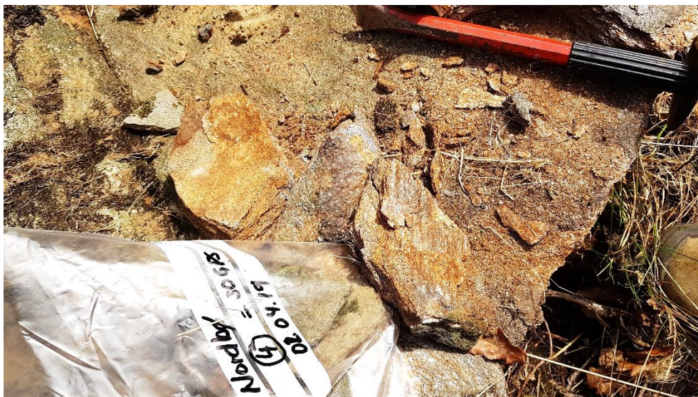
Figur 4: Båndgneis med høy glimmerandel. Prøven er skifrig med tydelig foliasjon, svovel 0,81 %, peroksidtest ingen reaksjon.
