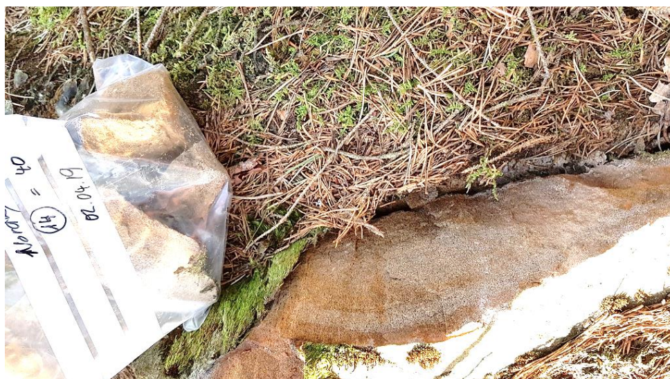
Figur 8: Kwarts-plagioklas-biotitt gneis, lyst og forvitret med oransje-gul forvitningsfarger, lite mørkerødt, svovel ubetydelig. Prøve nr. 14.
