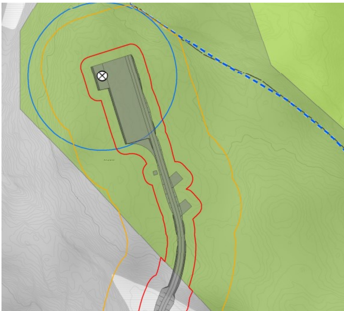
Figur 10: Kranoppstillingsplass nordligste turbin. Blå sirkel: rotorbladenes sveipesone. Stiplet blå linje: grense planområde. Rød linje: ytre inngrepsgrense. Gul linje: arealbruksgrense.
