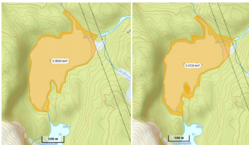
Figur 6. Areal av Svartetjørn med dagens HRV på bildet til venstre og med HRV +1,2 meter på bildet til høyre.
