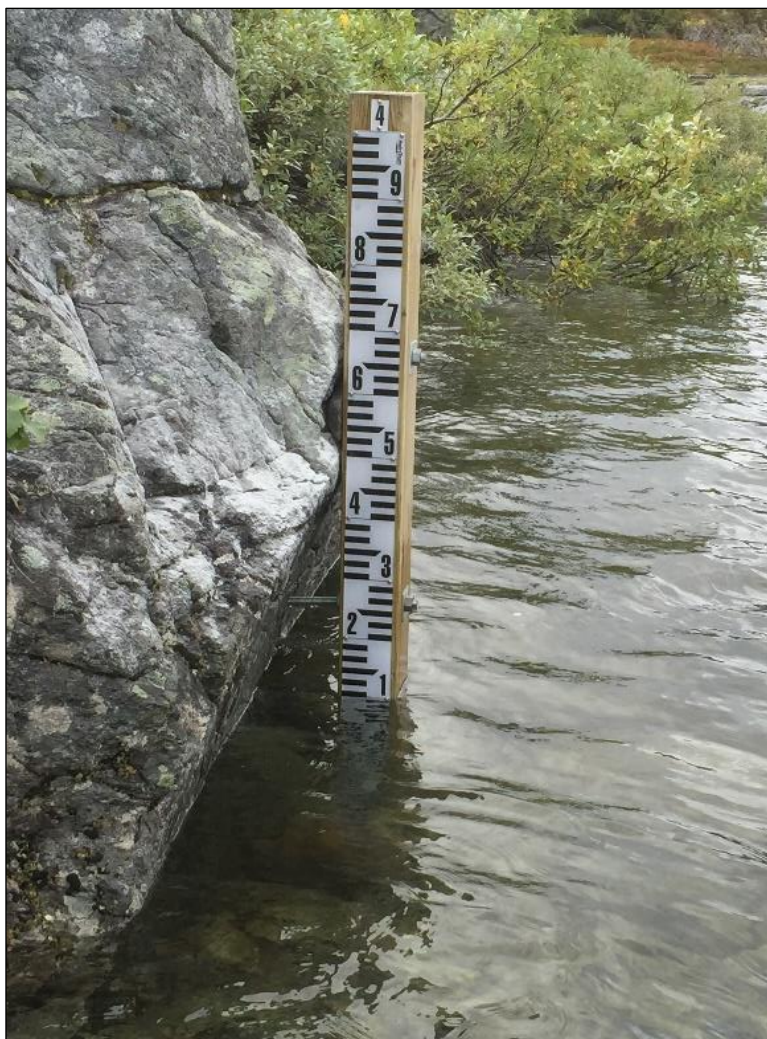
Figur 8. Eksempel på målestav (skala) for kontrollavlesning av vannstanden.
