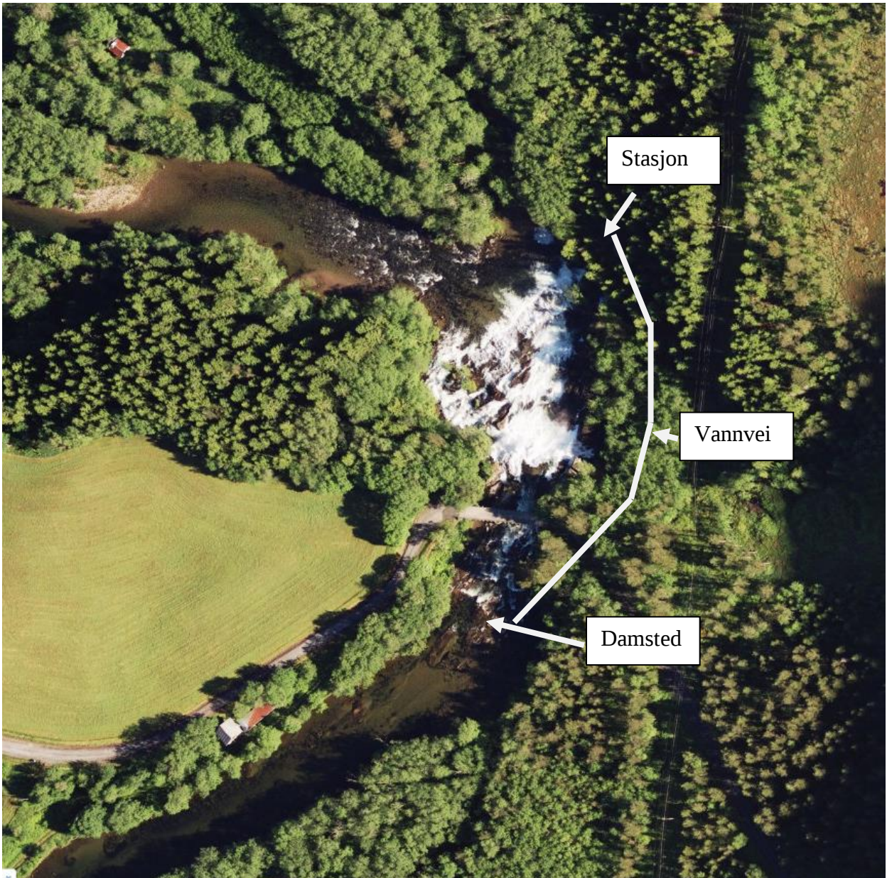
Figur 1: Damsted, rørtrasé og stasjon.
