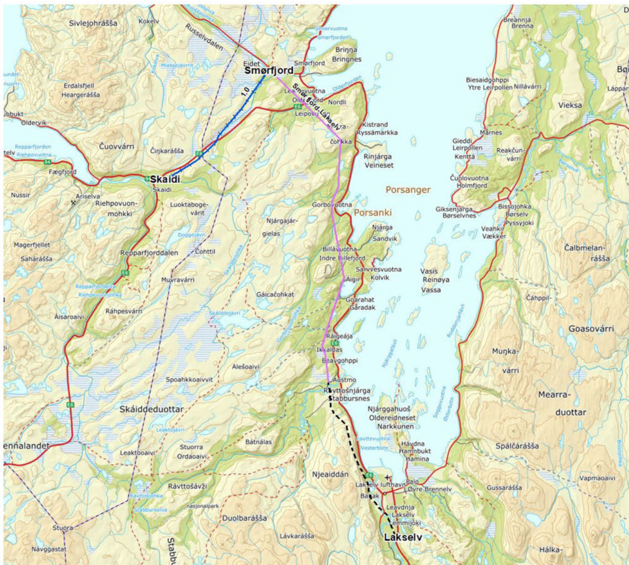
Figur 4-1. Ny ledning mellom Skaidi og Smørfjord (blå), nedgradering av eksisterende ledning mellom Smørfjord og Stabbursdalen (lilla) og riving av eksisterende ledning fra Stabbursdalen til Lakselv (sort stiplet).
