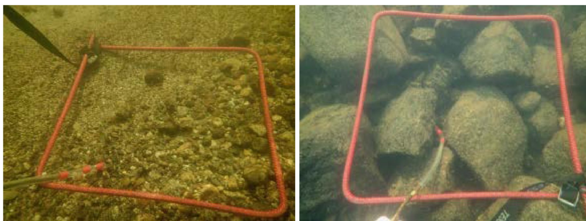
Figur 3.2. Skjulforhold for ungfisk måles ved å kvantifisere antall og størrelse på hulrom i elvebunnen med en plastslange innenfor en rute på 0,25 m 2 . Slangen er markert med røde markører som brukes til å måle størrelsen (dybde) av hulrommene. Eksempel på skjulmålinger i substrat med mye fin grus og sand hvor det ikke finnes hulrom, og dermed svært lite skjul (t.v.), og i substrat med stein/blokk som normalt gir mye skjul (t.h.). Foto: NORCE LFI.
