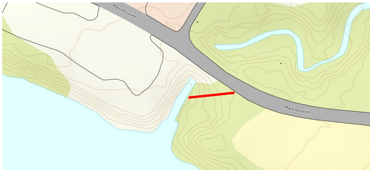
Figur 16: Anbefalt plassering av anleggsvei ved Leirbekken.
