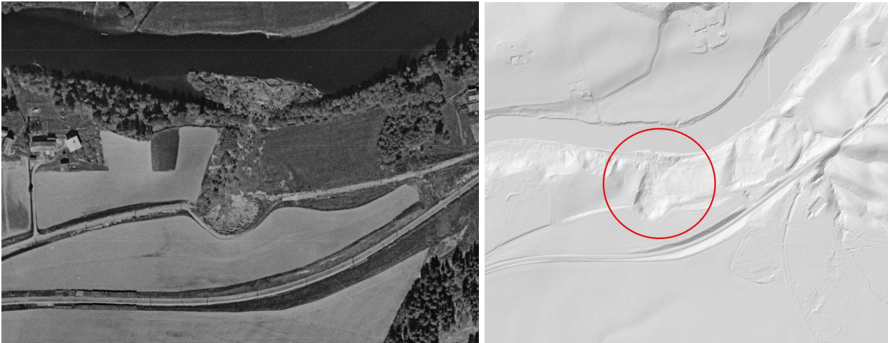
Figur 4.2 Flyfoto fra 1957 og terrengskanning fra høydedata hvor man kan se skredet og utløpsmassene fra skredet i Sogna
