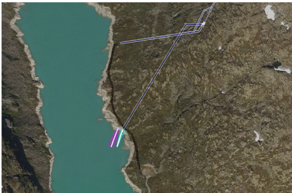
Figur 4. Førebels skisse av ledevoll (rosa) og kanal (grøn) ved utløp/inntak ved Fivlemyr. Ny veg er markert i svart og tunnelar er markert i kvitt (frå planendringssøknaden s. 9).
