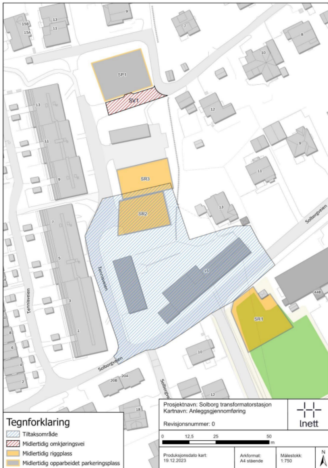
Figur 10: Oversikt over tiltaksområdet med riggplasser og anleggsvei for Solborg transformatorstasjon. Kilde: Lnetts konsesjonssøknad av desember 2023.
