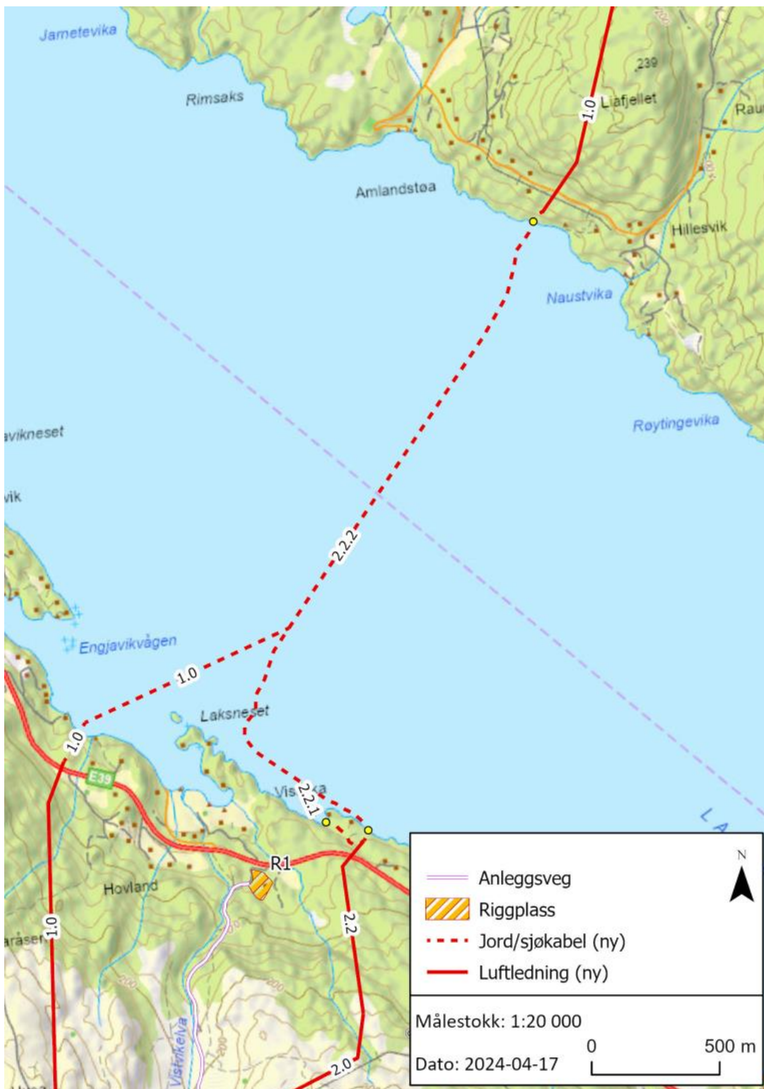
Figur 2-4. Omsøkte sjøkabeltraseer. Alt. 2.2.2 er fullt ut verifisert. For alt 1.0 forutsettes tilleggsutredninger for detaljering av trase ved valg av dette alternativet.
