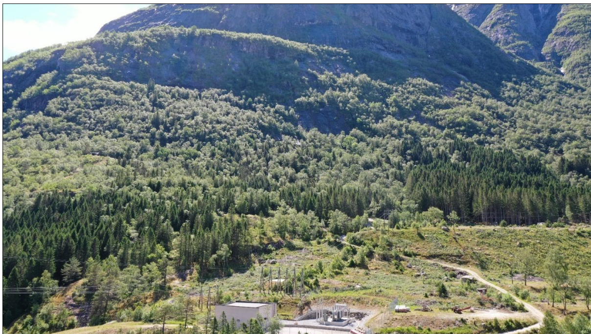
Figur 22: Dronebilde av Klyve stasjon og fjellsida opp mot Middagsnuten. I granskogen over stasjonen er det ein fjellrygg som leiir drenering og eventuelle lausmasseskred aust for stasjonen.
