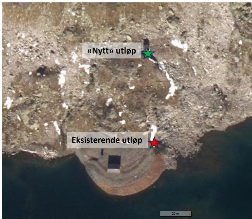
Figur 4-29. Utløp av overføringstunnel fra Isvatnet til Djupetjørn.
