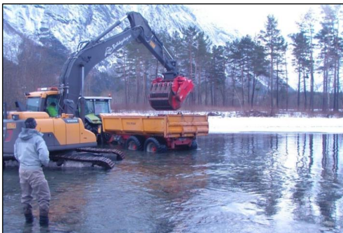
Figur 5-1: Bruk av trommelskuffe i Eira. (Bildet er hentet fra Jensen m.fl., 2014)
