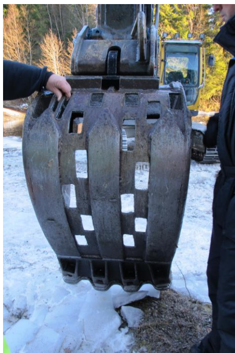
Figur 5-2: Spesialtilpasset grabb for fjerning av sand og småstein fra bunnsubstratet benyttet i Dalåa i 2013.
