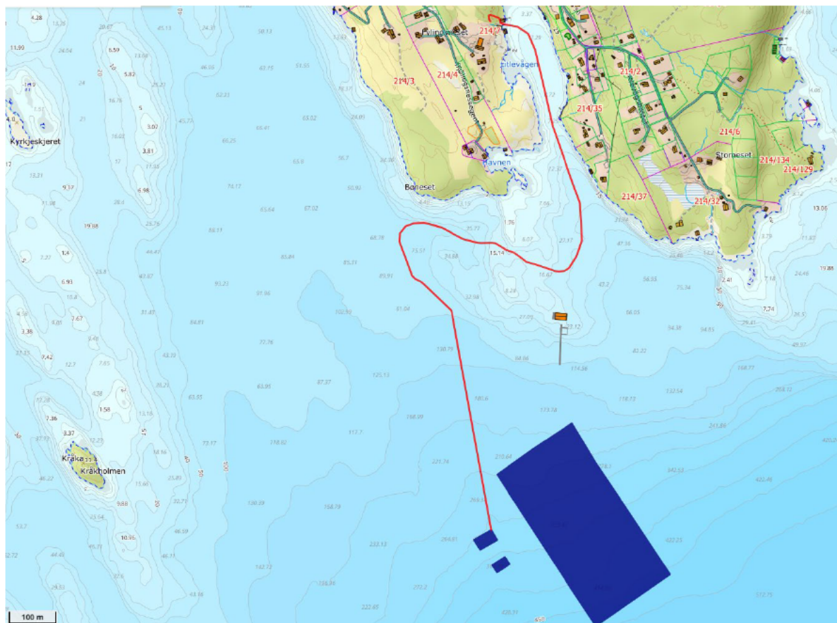
Figur 1. Oversiktskart – landstrømanlegg for oppdrettsanlegget Fyllingsnes. Trasé for jord- og sjøkabel fra Litlevågen til Fyllingsnes oppdrettsanlegg vist med rød linje. Kilde: Eide Fjordbruk sin konsesjonssøknad
