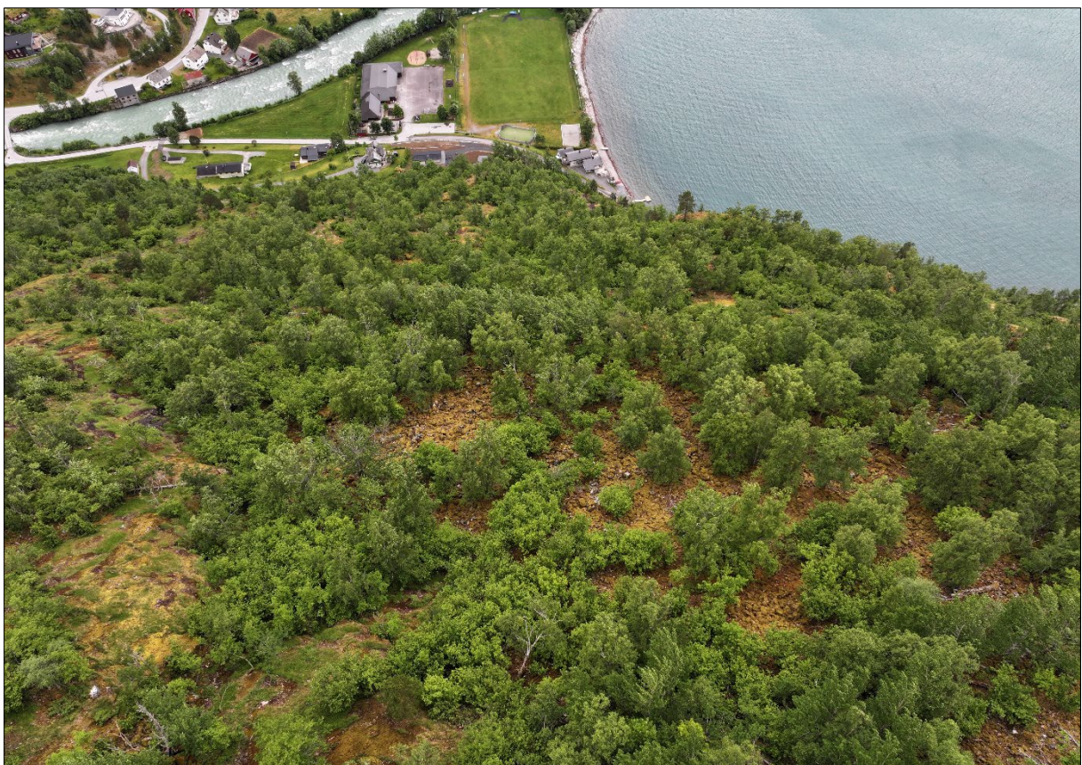
Figur 12: Dronebilete som viser nedre delar av påverknadsområdet. Det ligg steinsprangblokker i eit område mellom 210 – 150 moh., som òg kan sjåast på skyggerelieffkart og flyfoto.
