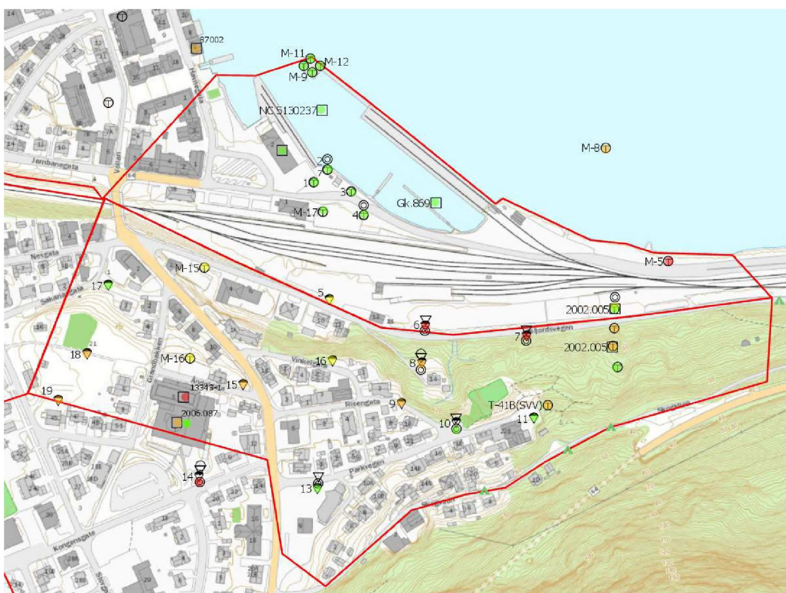
Figur 4 Plan detaljerte grunnundersøkelser. Fargekode boringer: Grønt – ikke kvikkleire, gult - mulig kvikkleire, oransje – antatt kvikkleire og rødt – påvist kvikkleire (prøver)
