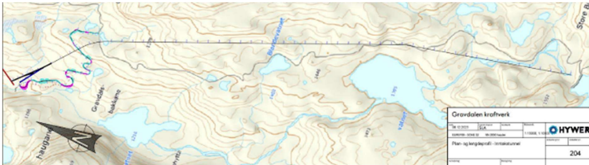
Figur 14 - Planprofil inntakstunnel frå Kvevotni til Gravdalen kraftverk.
