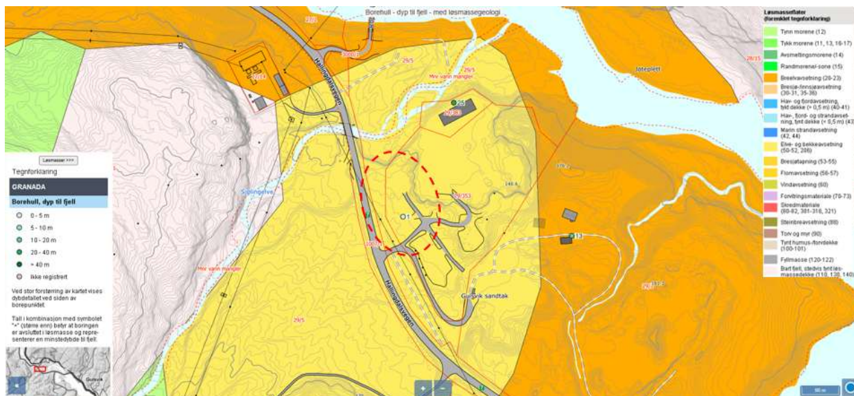
Figur 4 : Utklipp fra GRANDA [7] med NGUs løsmassekart som bakgrunnskart. Dybder til berg er fra 1 m i planområdet. I brønnen nord for planområdet er det 25 m til berg. Øst for planområdet er det 13 m til berg. Løsmassene i brønnene består av friksjonsmateriale av grus, sand og silt.
