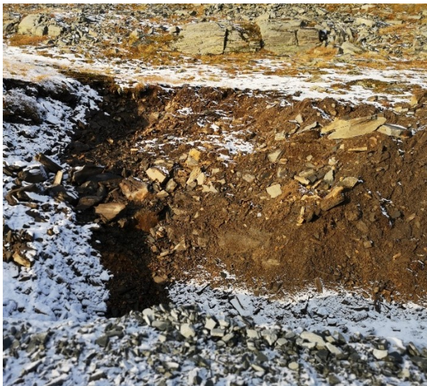
Bilde 5: Et typisk profil. Mye naturlig stein og varierende mengde fine masser. Humuslaget er tynt. I standsatte områder vil uansett preges av det store innslaget av stein, noe som i liten grad skiller seg fra omgivelsene. Løsmasseskjæringer må følges opp i driftsperioden med tanke på erosjon.
