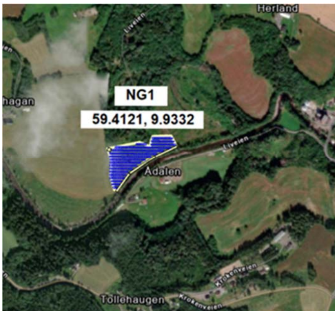
Figur 2-3: Grov skisse av plassering av panelrader for det vestre delområdet, NG1. Designet viser maksimal kapasitet på området. Hovedpunkt for tilknytning er foreløpig satt til nordvestre hjørne.
